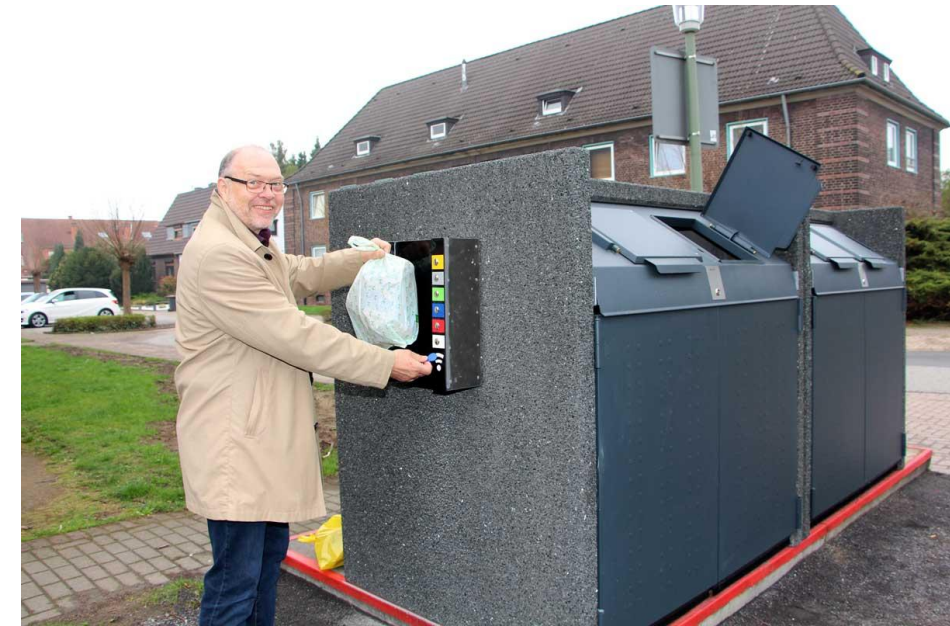
Versuch der Westfälischen Hochschule: Jede Art von Müll bekommt einen andersfarbigen Müllsack. Der spezielle Container erkennt die Farbe und öffnet die richtige Klappe. (Credit: Westfälische Hochschule)
